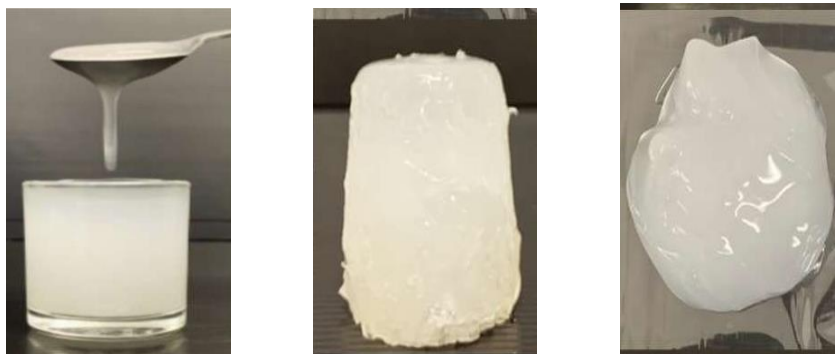
Hình 11. Gel sử dụng tinh bột biến tính với các hàm lượng lần lượt là: 6%, 10% và 15%
